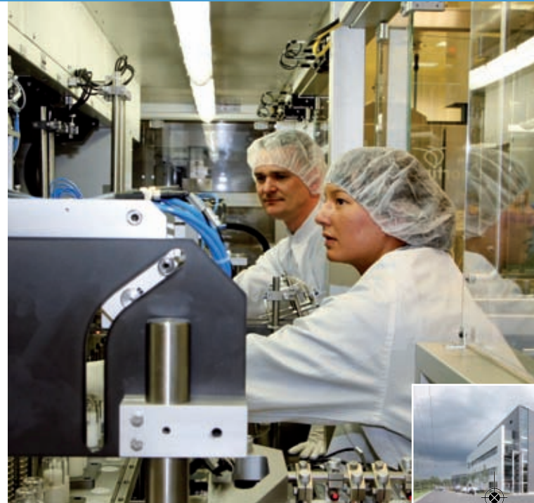
Die in die neue Zerstäuberfabrik eingebrachten Produktionsanlagen werden zurzeit getestet, so auch die vollautomatischen Montageanlagen.
